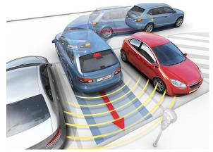
stationnement. Le système envoie les données numériques au service "cloud" de Bosch qui compare les données reçues aux cartes numériques et fournit aux conducteurs des informations sur l'emplacement des places de stationnement vides.
