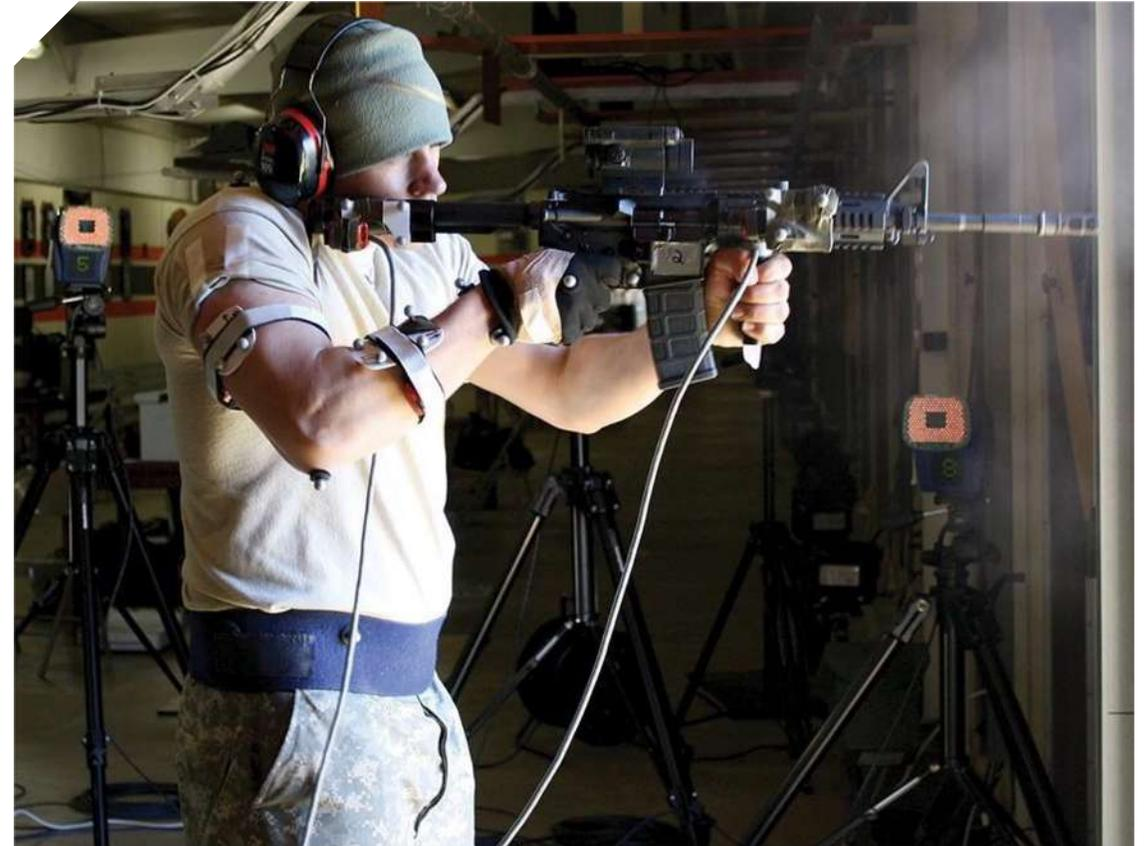
Usability-Test und Rückstossmessung eines Sturmgewehrs [\[Quelle: US Army\]](#).
