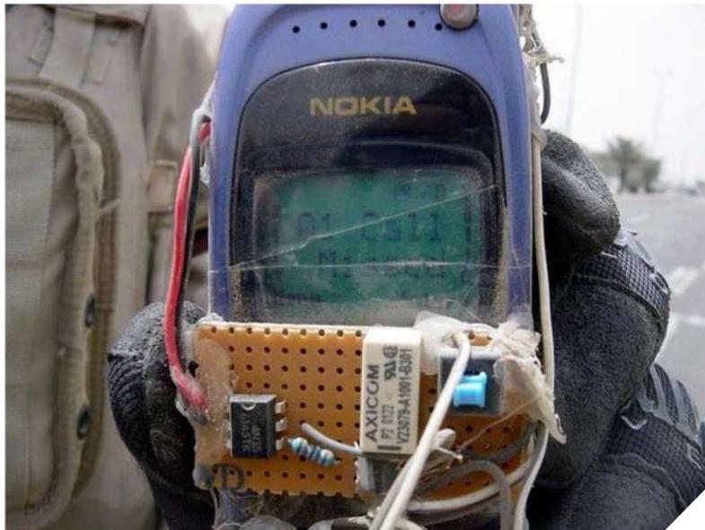
Beispiel für eine USBV (unkonventionelle Spreng- oder Brandvorrichtung) mit Fernauslösung per Telefon im Irak.
