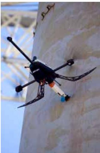
Voliro T: Diese Drohne kann einen konstanten Anpressdruck erzeugen, um beispielsweise strukturelle oder materielle Analysen durchzuführen. © Voliro AG
