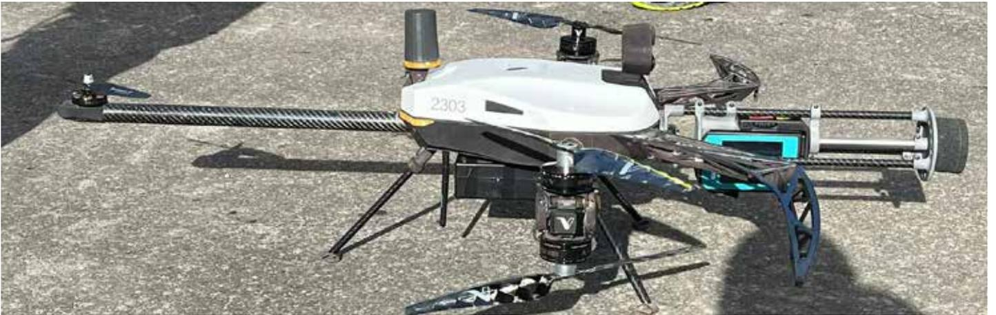
Die Voliro T Drohne mit dem eingebauten Raman-Sensor für die kontaktbasierte Identifikation von Chemikalien und Explosivstoffen. © Voliro AG
