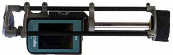
MIRA XTR DS: Dieser Raman-Sensor der Firma Metrohm wurde auf der Lanze der Drohne eingebaut, um die Materialidentifikation im Flug durchzuführen. © Metrohm Schweiz AG
